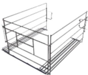
Вольер, с габаритами 170x130x100 см, изготавливается из металлической профильной трубы. Стандартная конструкция вольера включает два проема для установки ведер, и в передней части дверцу для обслуживания. Вольер хорошо используется в сочетании с пластиковым домиком, и имеет специальное крепление, что позволяет перемещать его и удобно при обслуживании загона.
